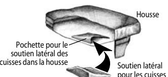
**Réassemblage du coussin Xtreme après nettoyage**
